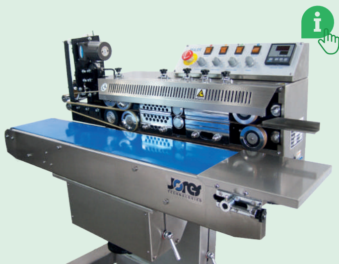
Selladora Digital Banda Continua Con Codificador CBS-1000
