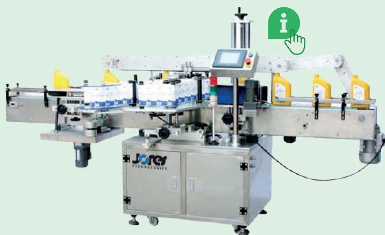
Etiquetadora automática Aplicador doble para envases planos OMICRON-2-LABELER
